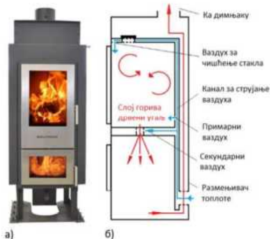
Слика 3.18 | а) Изглед пећи која користи гасификацију дрва, б) принцип рада пећи (Слика преузета из реф. [77]).
