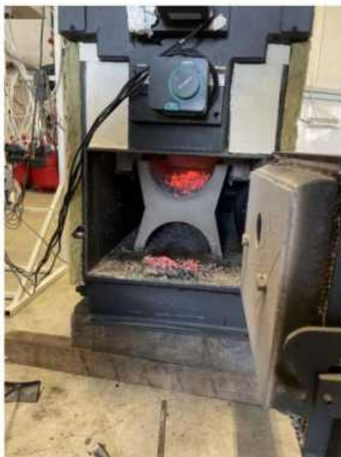
Слика 4.7 | Ватростална керамика коришћена у испитиваном гасификационом котлу на дрва приказаном на Слици 3.15.
