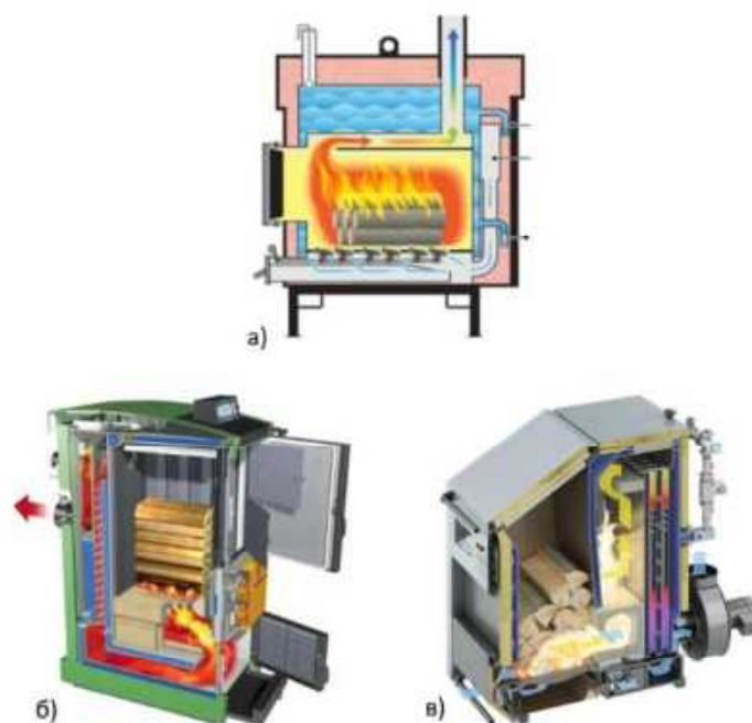
Слика 3.1 | Методе вишестепеног сагоревања дрвета: а) традиционално сагоревање навише, б) истосмерна гасификација, в) попречна гасификација (Слика преузета из референце [77]).
