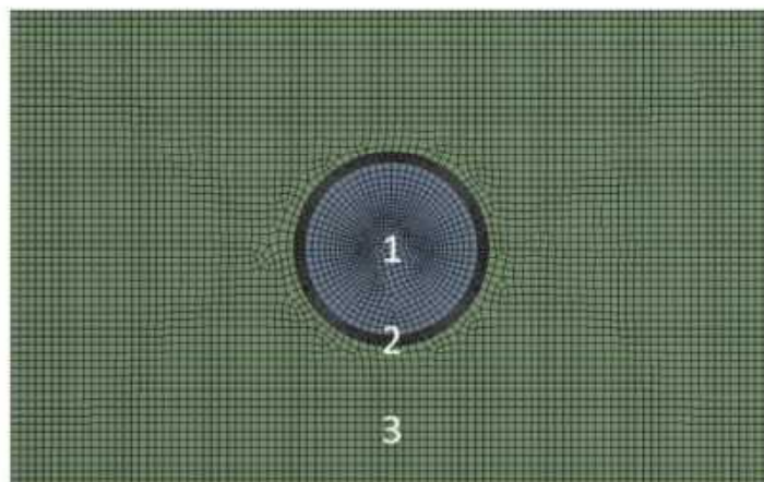
Слика 5.4 | 2D фина мрежа модела и области које су коришћене за нумеричке симулације; 1 – област димног гаса, 2 – димоводна цев, 3 – област котловске воде (Слика преузета из реф. [126]).
